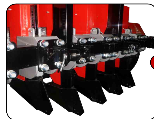
Ф. Передние сошники, регулируемые по высоте, для выбора глубины заделки.
